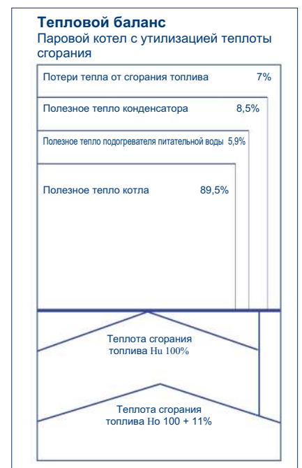
Рисунок 7: Тепловой баланс парового котла, работающего в соответствии с технологией утилизации теплоты сгорания
